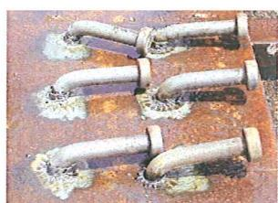
破壊打撃試験
