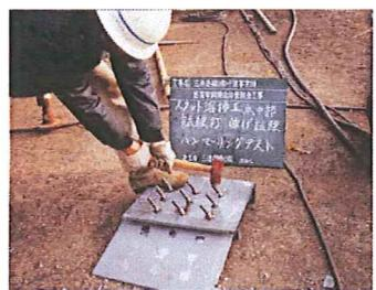
施工前の打撃試験状況
