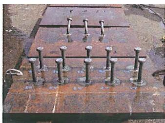
頭付き水中スタッド溶接の 溶接試験
